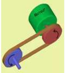
• Les poulies et courroies permettent la transmission d'un mouvement de rotation entre deux arbres relativement éloignés l'un de l'autre. L'entraînement est réalisé par l'adhérence de la courroie sur la poulie.
