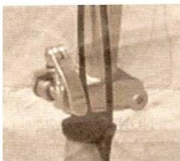
Le verrouillage parfaitement réalisé ne laisse aucun jeu dans l'assemblage du guidon et permet une utilisation en toute sécurité.
