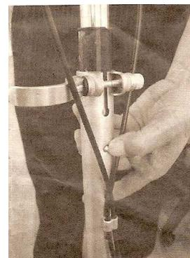
**-6-** Une fois la taille choisie et le cran correctement enclenché, faites attention à ce que la roue soit parfaitement perpendiculaire au guidon. Verrouillez l'assemblage comme pour les points **-2-** et **-4-**.
