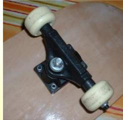
Quand les 4 écrous sont déssérés, soulever délicatement le truck de la planche en enlevant les vis une par une !
