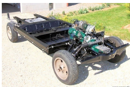
Voici le châssis plateforme d'une 4L
