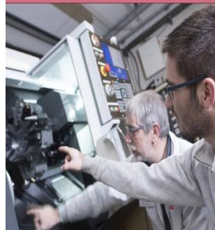
Le tourneur façonne les pièces métalliques à l'aide d'un tour à commande numérique ou manuelle. Il réalise des pièces métalliques par enlèvement de matière en conformité à un plan de définition.
