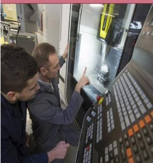
Le titulaire du bac pro TU fabrique des pièces mécaniques par enlèvement de matière (tournage et fraisage) et selon les cas, gère la fabrication. Il analyse des données techniques et fonctionnelles d'un ensemble, d'une pièce ou d'un composant pour établir un processus d'usinage et élaborer un programme avec le logiciel de FAO (Fabrication Assistée par Ordinateur). Il est également amené à contrôler et suivre la production.
