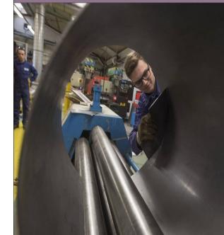
Le chaudronnier façonne des pièces métalliques pour leur donner forme. Qu'il s'agisse de travailler l'acier, le cuivre, l'aluminium ou encore le laiton, le chaudronnier est un métier qui requiert une grande dextérité manuelle, une précision d'artisan et des connaissances informatiques pour les simulations en 3D.
