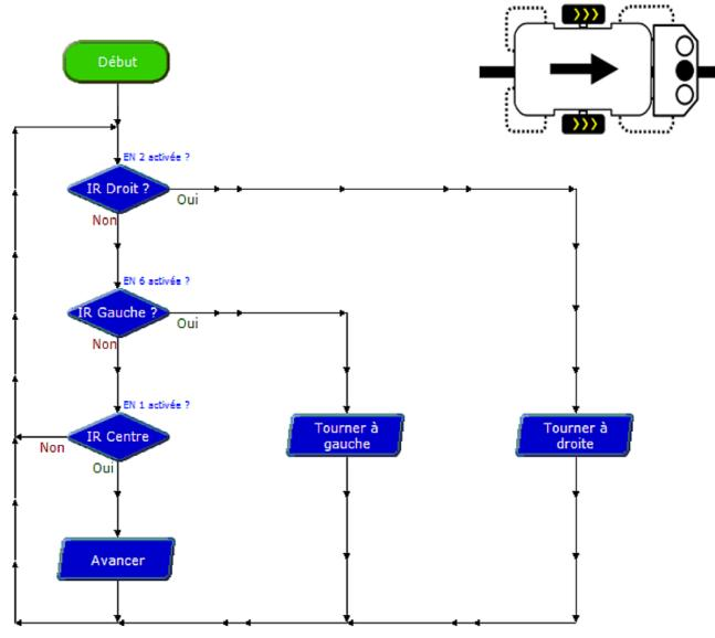
Tests successifs des entrées du module de pilotage qui correspondent aux 3 capteurs infrarouges de détection de marquage au sol :
