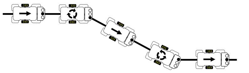
**Commentaire**: on remarque que le déplacement de MiniRobot est d'autant plus fluide que le parcours tracé au sol ne présente pas de « virages » serrés. Le programme suivant n'est pas prévu pour que MiniRobot détecte la présence de virages en épingle à cheveux. Si aucun des 3 capteurs ne détecte le tracé au sol, MiniRobot se met à tourner sur lui-même vers la droite.
