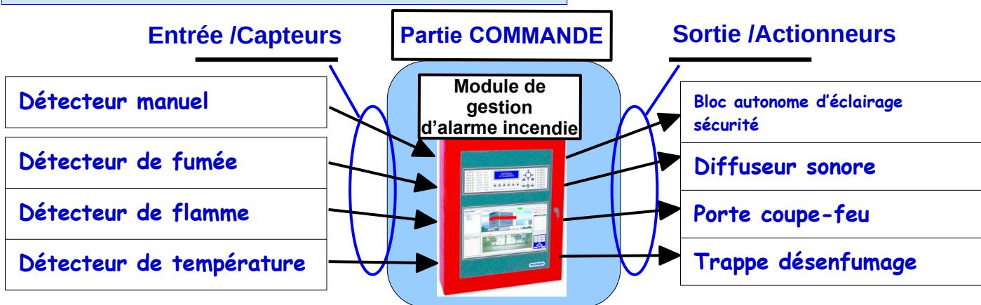
Le schéma de principe de fonctionnement : C'est la représentation qui permet de comprendre les échanges et le déroulement des actions dans le système.
