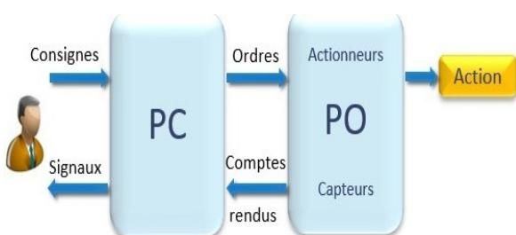
La structure des systèmes répertorie les constituants du dialogue entre la partie commande (PC) ("cerveau du système") et la partie opérative (PO qui regroupe actionneur et capteurs) et l'opérateur.
