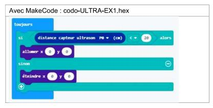
Niv2 : activer le module LED si la distance mesurée est inférieure à 20 cm et la réactiver quand l'objet détecté s'est éloigné de plus de 25 cm
