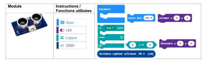
Niv1 : activer le module LED si la distance mesurée est inférieure à 20 cm sinon la désactiver
