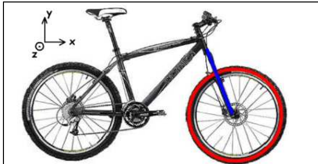
Liaison entre la fourche et la roue avant
