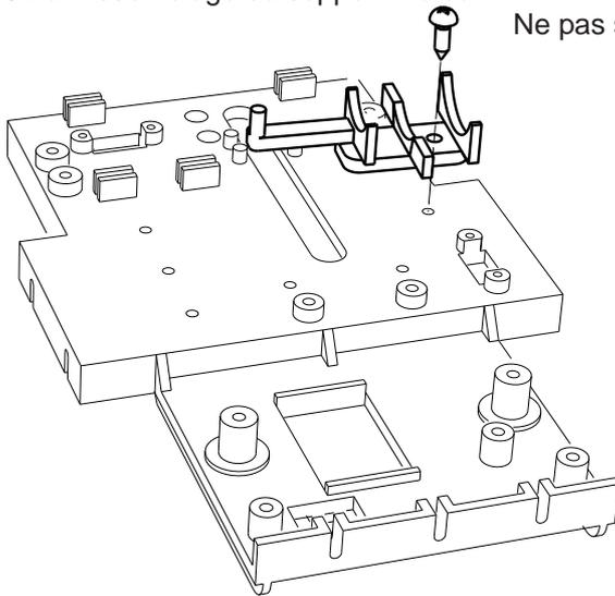
**132-b** Assemblage du moteur sur son support. Maintien par l'élastique.
