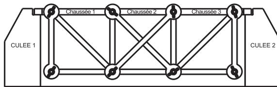
**STRUCTURE MODIFIEE** (remplacement de diagonales rigides par des diagonales souples)
