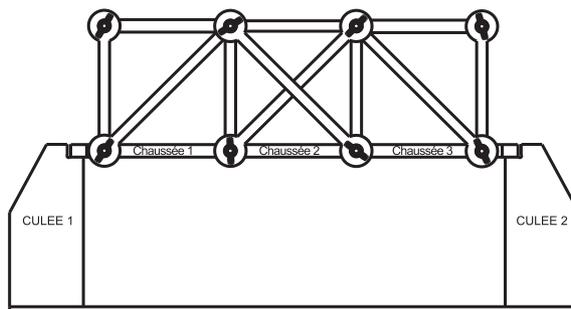
**STRUCTURE MODIFIEE** (remplacement de diagonales rigides par des diagonales souples)
