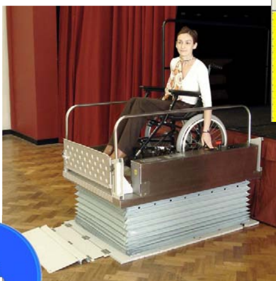
Maquette de plate-forme élevatrice automatisée pour personnes à mobilité réduite
