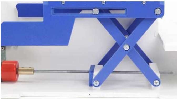
Mécanisme tige filetée – écrou - ciseaux
