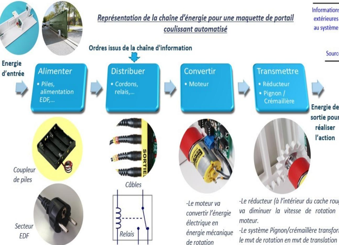
Schéma global Chaîne d'énergie / Chaîne d'information
