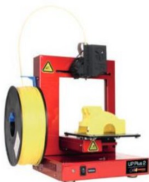
Imprimante 3D à filament fondu
