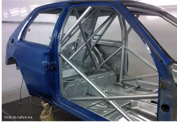
Contrairement à un châssis échelle, un châssis coque est beaucoup plus difficile à récupérer en cas de déformation. C'est donc presque systématiquement irréparable et il faut alors condamner l'auto à finir à la casse ...
