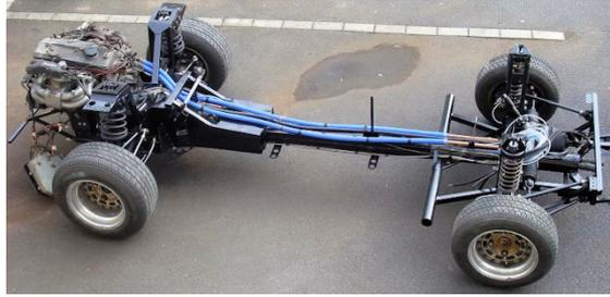
Ce type de châssis repose principalement sur une poutre centrale de gros calibre qui parcourt le véhicule dans sa longueur. La carrosserie est fixée au dessus de cette dernière, il y a donc séparation entre cellule / habitacle et châssis. Sa résistance face aux chocs latéraux est logiquement moyenne ... On parle souvent de l'ancienne Alpine pour désigner un exemple de voiture qui bénéficie de cette architecture.
