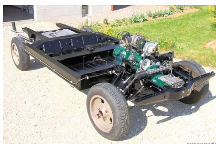
Voici le châssis plateforme d'une 4L
