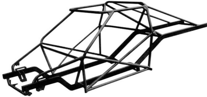
Le châssis tubulaire est destiné à la compétition. Il associe à la fois un poids très léger (il y a beaucoup de vide) et une rigidité importante. Les tubes en forme ronde permettent justement cela, car la forme circulaire est la plus résistante qui soit grâce à une répartition des forces très homogène (des tubes carrés sont bien moins résistants, voilà pourquoi les cadres de vos vélos, entre autres, sont généralement ronds).
