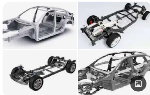
Le châssis du véhicule est le principal soutien de la structure du véhicule à moteur sur lequel tous les autres composants sont attachés. Jusqu'aux années 1930, pratiquement chaque voiture avait un châssis séparé de sa carrosserie. Cette conception est connue comme carrosserie-sur-châssis. Wikipédia >
