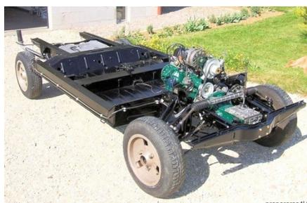
Voici le châssis plateforme d'une 4L
