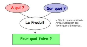
Le diagramme « bête à cornes » est le **schéma normalisé de l'expression du besoin.** Le produit rend service au client en agissant sur la matière d'œuvre pour satisfaire le besoin.
