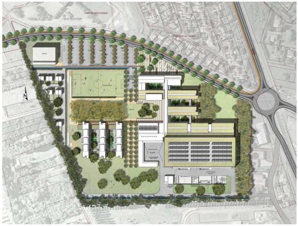
L'aménagement du site choisi pour la construction du lycée permet de **concilier** la construction ultérieure d'un **gymnase**, le stationnement de 150 places des véhicules légers, **la dépose des autobus** de transports en commun, la desserte des logements de fonction et du parking des visiteurs, ainsi que la création en bordure de la nouvelle voie d'un **vaste parvis**, ménageant l'accès des élèves et des professeurs au lycée.
